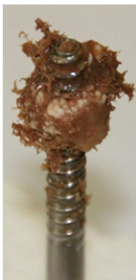
Obr. 2. Ukázka vytržených šroubů.
