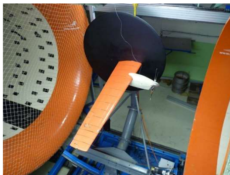
Obr. 2. Aeroelastický experiment, aeroelastický demonstrátor pro výzkum vířivého flutteru.
