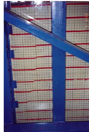
Obr. 2. Zakřivená smyková plocha ve zkušebním tělese po aktivním (od tělesa) otáčení čelní stěny okolo vrcholu. Vyklonění vrcholu stěny bylo 8,75 mm, velikost ok černé sítě na skle je 20/20 mm.
