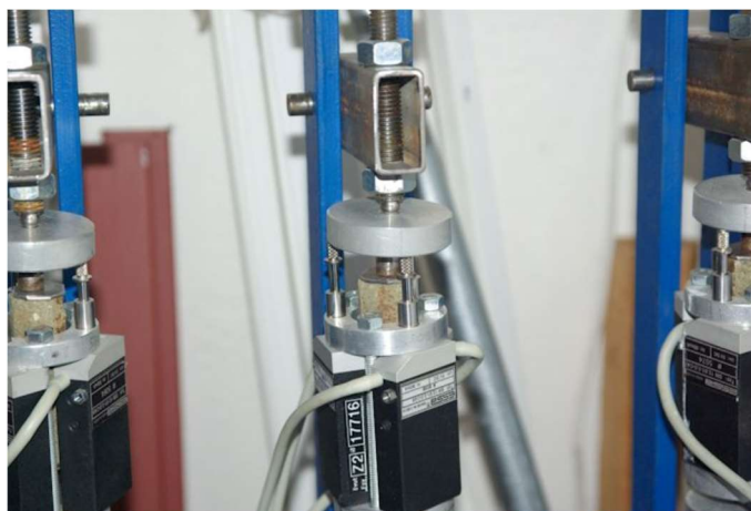
Obr. 1. Zkušební zařízení pro měření smrštění nepálené hlíny.
