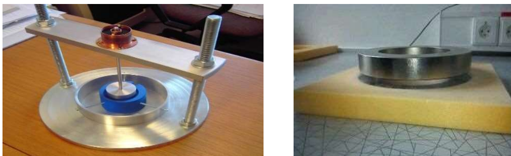
Obr. 3. Axiálně-radiální bezdotykové uložení (levitace) na supravodivém principu vyžadující chlazení speciálního supravodivého materiálu alespoň na teplotu kapalného dusíku.
