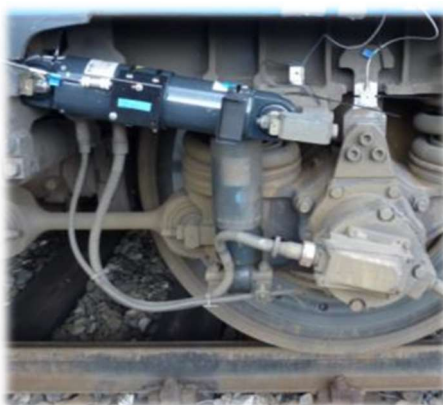
Obr. 2. Analýza jízdních vlastností lokomotivy s využitím instrumentovaných tlumičů vrtivých pohybů podvozek–skříň v provozních podmínkách.
