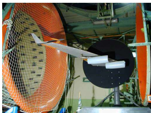
Obr. 1. Aeroelastický experiment, model křídla velkého dopravního letounu (EuRAM).
