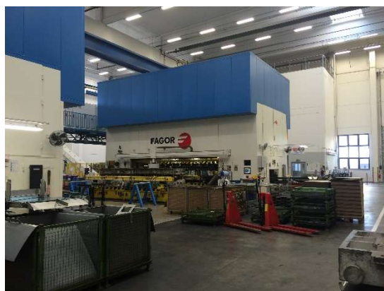
Obr. 2. Betonová vana připravená pro výstavbu dvojice rámových základů Fagor; instalovaná dvojice lisů Fagor (foto D. Makovička).
