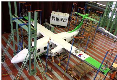
Obr. 1. Modální zkouška malého dopravního letounu.
