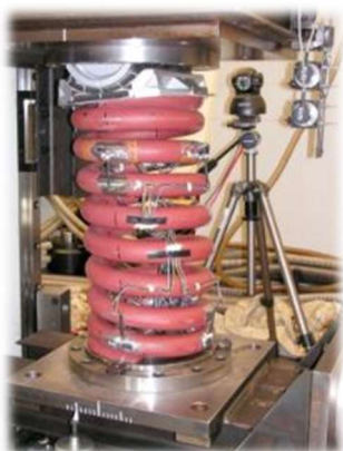
Obr. 1. Svisle a příčně zatěžovaná pružina z podvozku lokomotivy v sestavě s pryž-kovovou naklápací podložkou.
