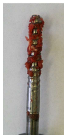
Obr. 2. Ukázka vytržených šroubů.
