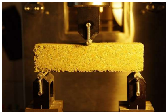
Obr. 1. Zkouška pevnosti v tlaku s měřením axiální deformace. Obr. 2. Třibodová ohybová zkouška tělesa z dusané hlíny.
