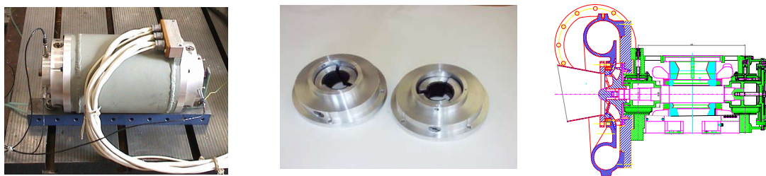
Obr. 1. Aerodynamická radiální ložiska se třemi naklápěcími segmenty – zkušební motor a průmyslová aplikace – bezdotykové uložení 100 kW turbodmychadla ATUR.
