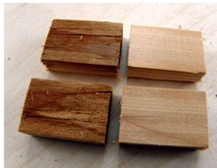
Obr. 1. a) Nedeštruktivní analýza hořického pískovce pomocí ultrazvuku, b) vzorky dřeva pro určení pevnosti materiálu bez poškození a s rozvlákněnou vrchní vrstvou.
