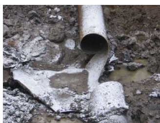
Obr. 1. Havárie plynovodu DN500, zkušební trubní těleso DN500 po protržení trhliny a R křivka pro trubní ocel.
