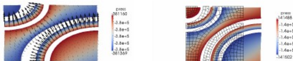
Obr. 2. Ilustrace výpočtu deformačně difuzních procesů v porézním materiálu s tzv. duální porozitou. Rozložení tlaku v části duální porozity v reprezentativním objemu periodické mikrostruktury. Rozložení rychlosti tekutiny (vlevo) a deformace (vpravo). Model s uvažováním velkých deformací v rámci aktualizované Lagrangeovy formulace. Model lze využít pro simulace tkáňového prokrvení měkkých tkání.
