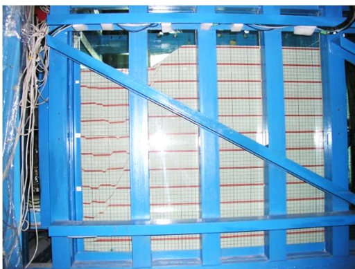
Obr. 1. Pohled na deformované syké těleso při experimentu E7/0,3 po posunu stěny vlevo o 74,04 mm (deformace viz červené proužky, smykové plochy viz porušení proužků).
