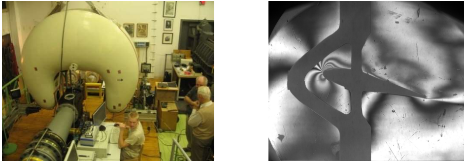
Obr. 2. Pohled do laboratoře v Novém Kníně se zavěšeným interferometrem a příklad interferogramu proudového pole během kmitání.
