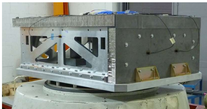
Obr. 1. Demonstrátor nosné struktury satelitu s integrovanou vrstvou radiačního stínění při vibračních zkouškách.
