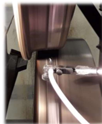
Obr. 3. Laboratorní výzkum adheze mezi kolem a kolejnicí při různých podmínkách a stavech kontaktní plochy.
