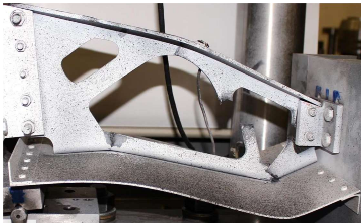
Obr. 3. Intercostal po destrukci ve statickém testu.
