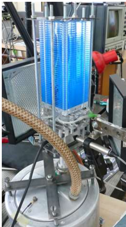
Obr. 1. Vlevo je experimentální model fonace člověka. Do modelu plic je přiváděn vzduch a odtud modelem průdušnice do podhlasivkového prostoru, který je osazen tlakovými snímači, a dále pak k silikonovému modelu hlasivek, odkud prochází modelem vokálního traktu (VT) pro samohlásku [i:] do otevřeného prostoru. Kmitání hlasivek (VF) je snímáno rychlostní kamerou umístěnou nad vokálním traktem spolu s mikrofonem měřícím vyzařovaný zvuk. Modely VT a VF byly získány z CT dat naměřených při fonaci člověka. Vpravo jsou naměřené tlakové signály v subglotickém prostoru pod modelem hlasivky ( P_{sub} ), v modelu VT pro samohlásku [u:] těsně nad hlasivkou ( P_{larynx} ), v modelu ústní dutiny ( P_{oral} ) a mikrofonní signál (Mic) měřený vně VT během sedmi period kmitání hlasivek. Pod časovými signály jsou zobrazeny záznamy rychlostní kamery ukazující vibrace hlasivkové štěrbině během jedné periody. Čas uzavření hlasivkového kanálu činí 41% periody kmitání, což odpovídá lidskému hlasu. CQ = T_{closed} / T_{period} = 0.41
