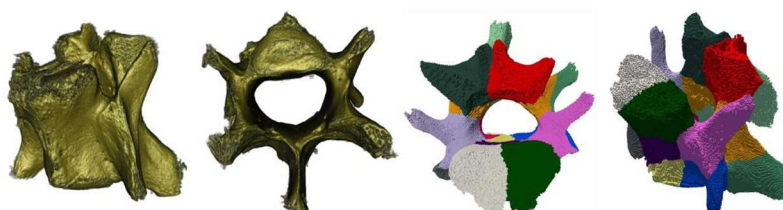
Obr. 2. Tvorba MKP modelu kryšního obratle L3. Vlevo vizualizace povrchu obratle včetně detailů. Vpravo voxelový MKP model s barevně odlišenými oblastmi pro paralelní MKP řešič.
