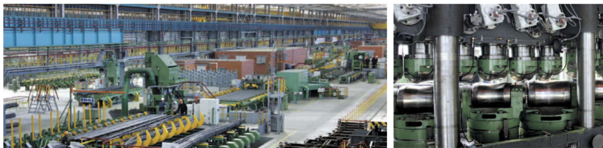
Obr. 1. Inspekční linka, pohled na víceválcovou rovnačku.
