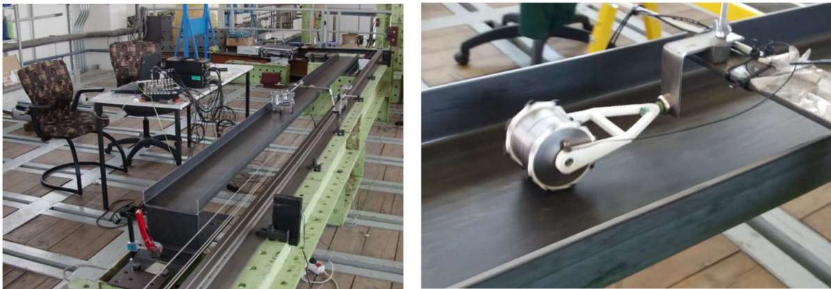
Obr. 2. Pohled na zařízení pro vývoj metodiky "Drive-by Identification".
