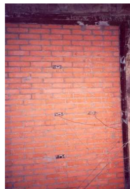
Obr. 5. Pohled na zeď se snímači před měřením vlastních frekvencí.
