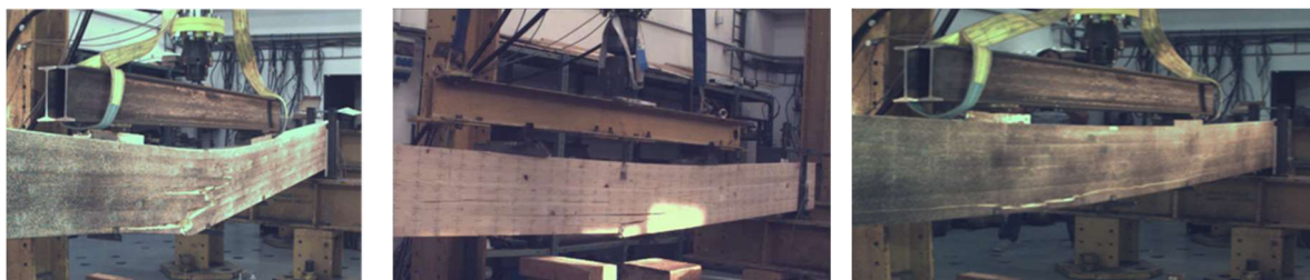
Obr. 1. Destrukce nosníků při ohybových testech v případě nevhodně seskupených zubovitých spojů (vlevo), ze zubovitého spoje uprostřed spodní lamely (uprostřed) a podélnou trhlinou ve spodní lamele (vpravo).
