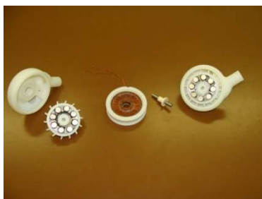
Obr. 6. Umělé srdce založené na vířivém principu kvůli snížení smykových napětí v kapalině. Pro pohon dvou oběžných kol současně je použito diskového motoru.
