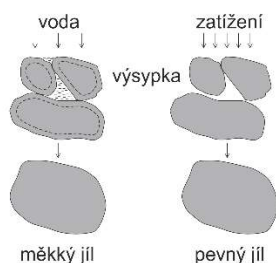
Obr. 1. Proces měknutí materiálu výsypky vlivem zatížení a přijímání vody.
