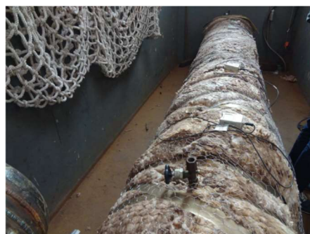
Obr. 1. Výsledné křivky přirozeného časového poklesu tlaku vody z poměrné hodnoty p_0 / p_{0,2} a foto zaizolované zkušební trubky DN500 pro ověření přirozeného poklesu tlaku vody s časem.
