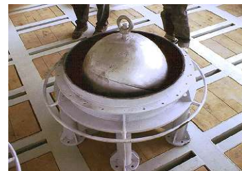
Obr. 3. Schéma, matematický model a realizace kulového tlumiče vibrací.
