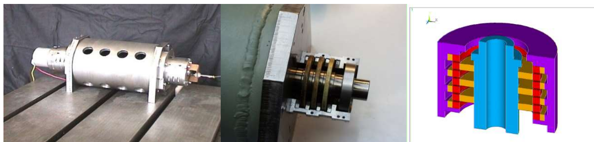
Obr. 2. Radiální ložiska s permanentními magnety a zpětnovazebním elektromagnetickým axiálním ložiskem zajišťujícím stabilitu – zkušební rotor, sestava axiálně magnetovaných kroužků ložiska.
