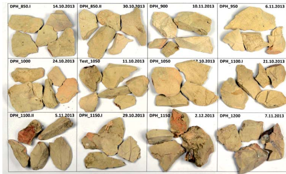
OBRÁZEK 135: Srovnání barvy přirozeně hydraulického vápna po výpalu od 850 do 1200 °C. Velikostní frakce 10–15 mm
