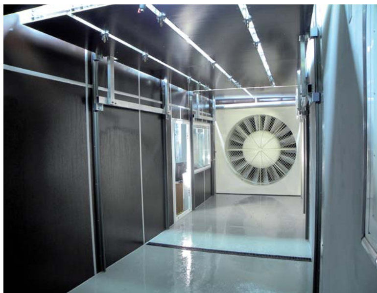
OBRÁZEK 212: Klimatická komora s 200kW ventilátorem. Komora je připravena pro uchycení vzorků do otvorů v podlaze. Pohyblivý strop umožňuje operativní manipulaci s vodními tryskami či se sálavými lampami.
