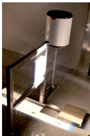
OBRÁZEK 231: Panel s mozaikou umístěný v klimatickém tunelu. Na tomto zkušební prvku byla zkoušena rezistence dílků a pojiva proti větru s hnaným deštěm. Intenzita deště byla měřena laserovým srážkoměrem. Byla též zkoumána varianta, kdy je část mozaiky vystavena negativním tlakům, tedy sání v kombinaci s deštěm.
