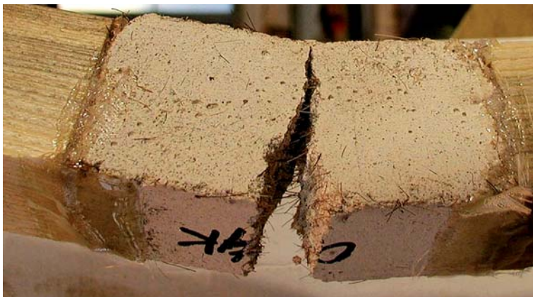
OBRÁZEK 3: Ukázka způsobu zesílení lepeného spoje podkladní bandáží
