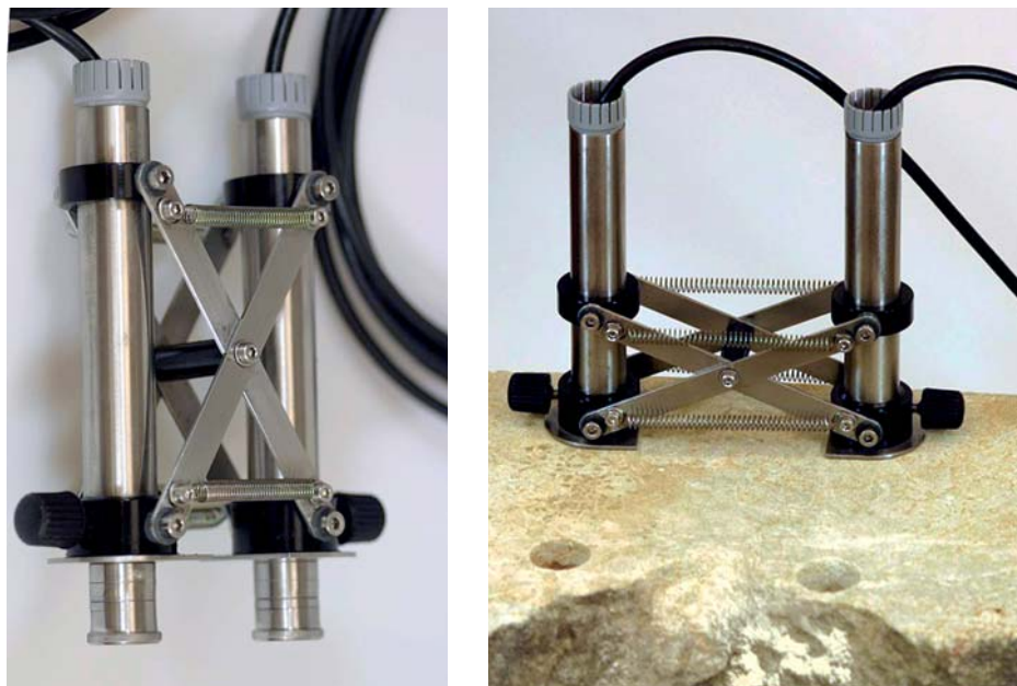
OBRÁZEK 207: Přenosná ultrazvuková dvojitá sonda pro měření materiálových vlastností v hloubkovém profilu a hodnocení hloubky penetrace v povrchové vrstvě mezi dvěma vyvrtanými otvory (Foto J. Valach)
