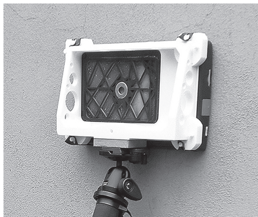
OBRÁZEK 259: Přenosný skener pro měření barevnosti a znečištění povrchu (Foto J. Valach)
