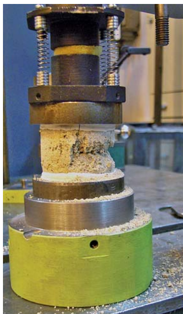
OBRÁZEK 152: Zkouška pevnosti v tlaku
