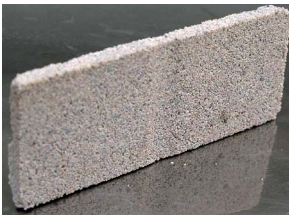
OBRÁZEK 151: Tenká deska pro tahovou zkoušku
