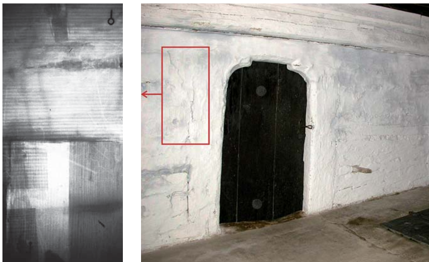
OBRÁZEK 185: Rentgen styku sloupku a překlada dřevěné zárubně pod nátěry vápnem (Trstenice). Dobře je patrné zapuštění vodorovných dřev roubené stěny do sloupku zárubně (vlevo). Rentgenovaná zárubeň v Čisté (vpravo). Dřevo zárubně i roubenice je skryté pod vrstvami vápenných pačoků.
