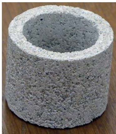
OBRÁZEK 150: Těleso pro tlakové zkoušky
