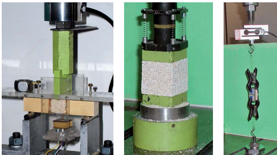
OBRÁZEK 206: Uspořádání zkoušky ohybem na protézovaném vzorku (vlevo), tlakové zkoušky (střed) a tahové zkoušky (vpravo) na tělesech ze zhutněného písku nebo kamenné drti (Foto M. Drdáčký, P. Zíma)
