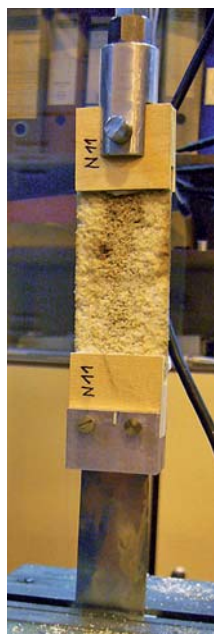
OBRÁZEK 153: Zkouška pevnosti v tahu
