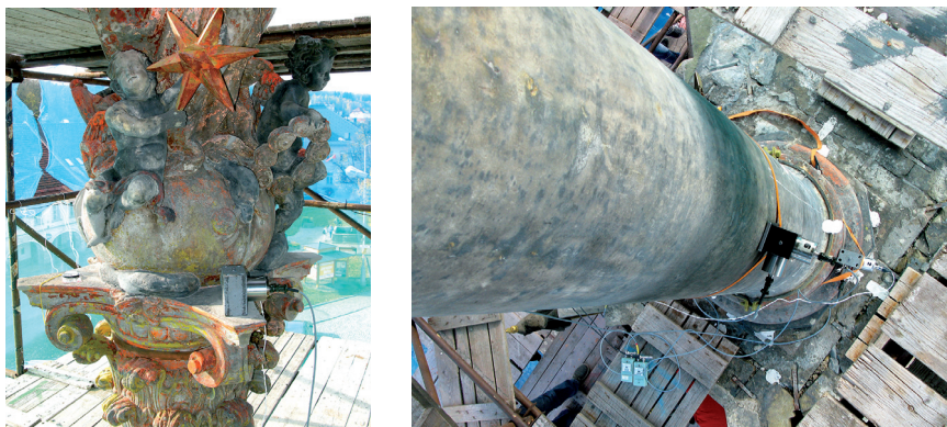
OBRÁZEK 261: Umístění snímačů kmitání v úrovni hlavice sloupu (vlevo) a na dřívku (vpravo)
