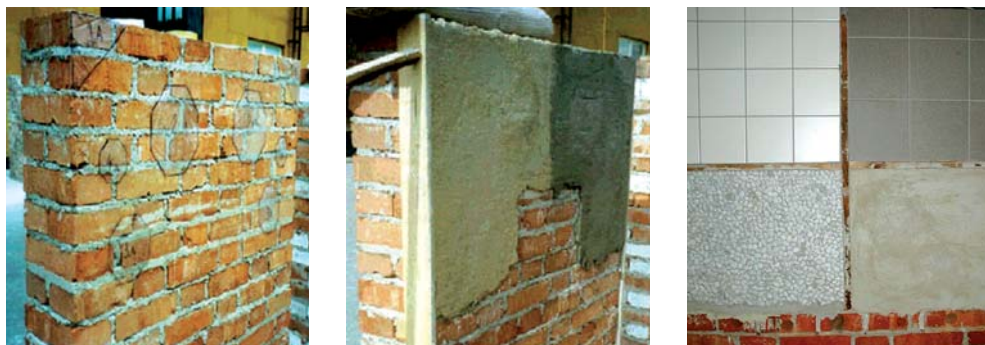
OBRÁZEK 176: Příprava modelové zdi se separačními fóliemi, které zabraňovaly kontaktu omítky se zdivem a tak modelovaly odtržení omítky nebo obkladu od povrchu (vlevo), zeď při omítání (střed) a kombinace omítky s obklady a mozaikou
