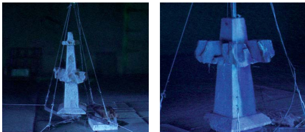
OBRÁZEK 217: Metodika použití fosforeskující přísady v dešťových kapkách a vizualizace smáčení deštěm. Vlevo – hydrofobizovaná fiála, vítr 10 m/s, vpravo – fiála bez ošetření, vítr 10 m/s. Světlá barva značí plochy, které jsou intenzivně smáčené deštěm.
