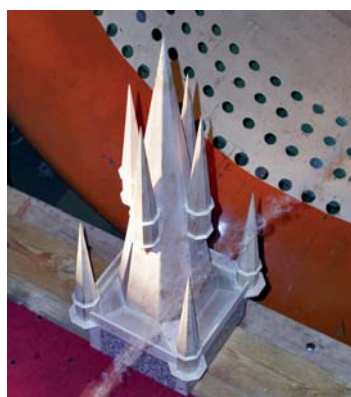
OBRÁZEK 222: Vlevo – sledování proudění vzduchu kolem věže pomocí kouře. Vpravo – výsledek numerické simulace proudění vzduchu kolem vrcholu staré historické věže s věžičkami. Tmavá barva představuje nižší rychlost.
