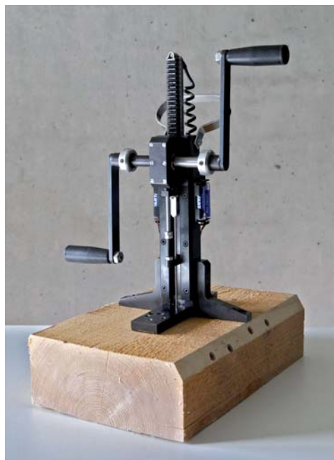
OBRÁZEK 16: Přístroj pro měření mechanického odporu dřeva při zatačování trnu
