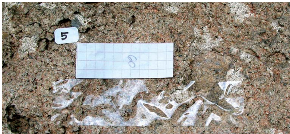
OBRÁZEK 37: Dva typy pásek aplikované pro měření na historických omítkách hradu Pernštejna
