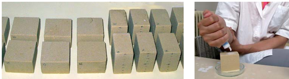
OBRÁZEK 160: Sada zkušebních těles maastrichtského vápence (vlevo) a postup zpeňování jednoho vzorku smáčením povrchu kamene vápennou nanodisperzí pomocí injekční stříkačky (vpravo)
