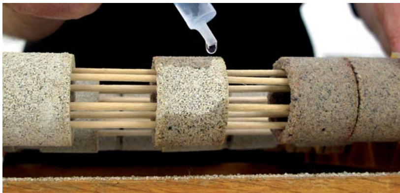
OBRÁZEK 154: Penetrování tenkostěnných rour pro tlakové zkoušky
