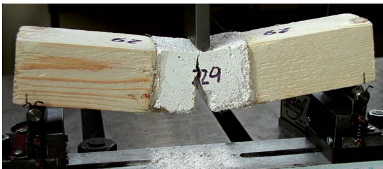
OBRÁZEK 4: Příklad zkoušky protézované malty vyztužené vlákny
