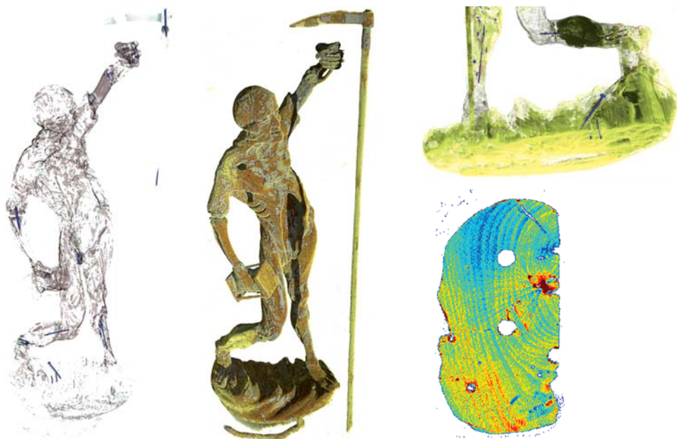
OBRAZEK 255: Vlevo je vizualizace kovových spojovacích prvků a fragmentů povrchových vrstev; uprostřed je dřevorezba obarvená dle hustoty materiálu se zvýrazněnými fragmenty polychromie; vpravo nahoře je detail spodní části, dobře viditelný hřebíček a výrazně jiná struktura pravého lýtko – zřejmě doplňování materiálu během pozdějších zásahů; vpravo dole je vodorovný řez podstavy, s patrnými chodbičkami červotoče, uprostřed v levé části „vodorovná“ prasklina, v horní části je další prasklina zasahující ke kraji, červená skvrna vpravo nad středem odpovídá přítomnosti kovových prvků.
