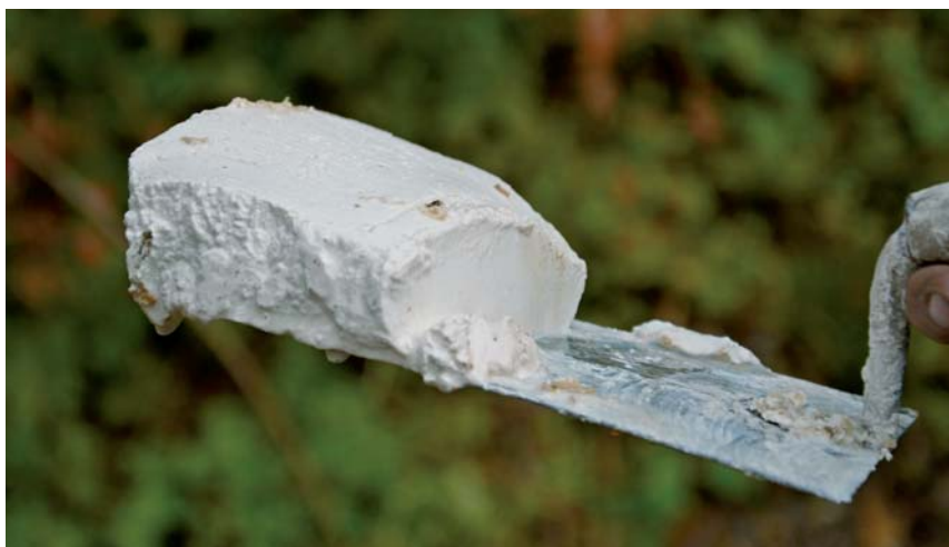
OBRÁZEK 134: Dva roky odležená vápenná kaše má pevnou konzistenci a drží tvar po vyjmutí z jámy
